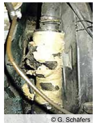
Abb. 7.29: Vom Steinmarder zerbissener Kühlschlauch.
